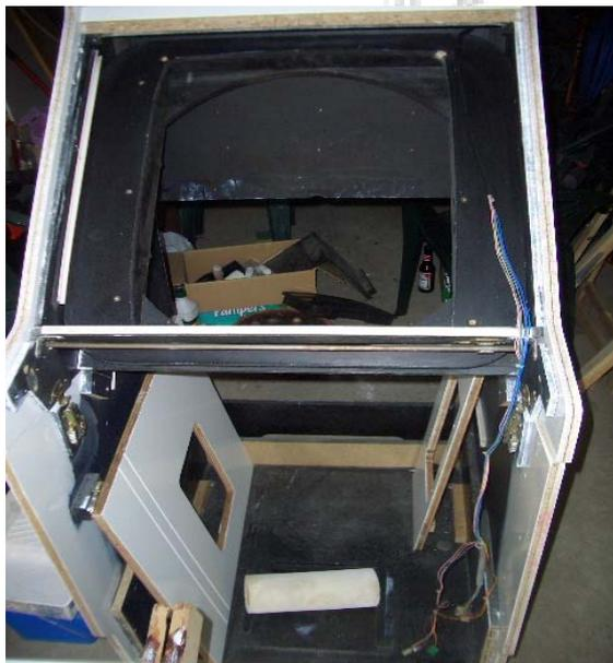
Le haut de la borne peut être séparé du bas, il suffit de retirer quelques vis à l'arrière.
